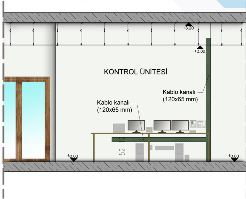
Kesit 3.1 Kontrol ünitesi kablo kanalı yerleşimi (Ölçeksiz)
