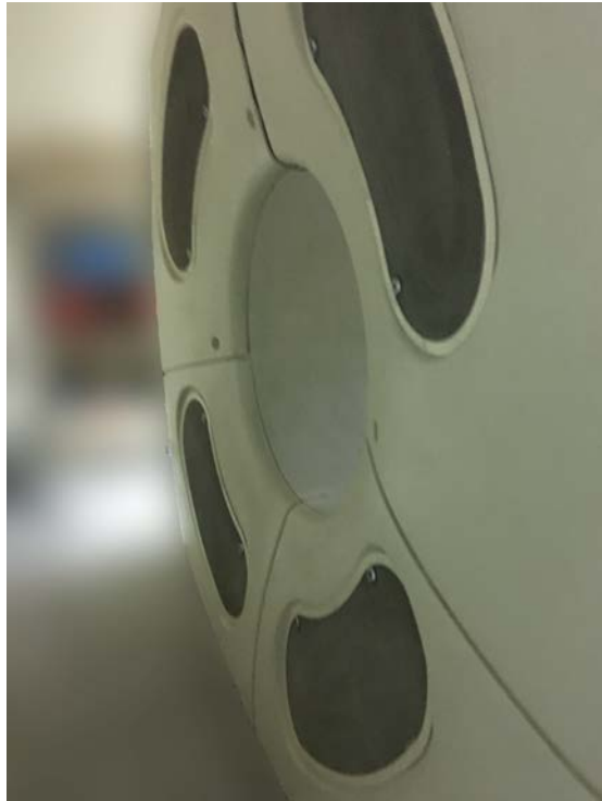
Resim 3.1 Tomoterapi ünitesi hava emiş kanalları
