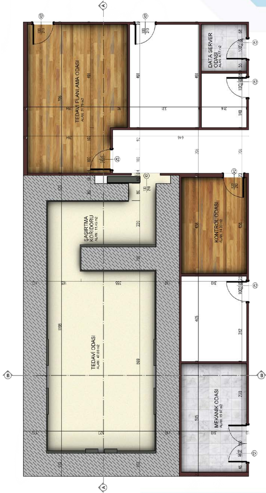
Plan 4.2 Tomoterapi tedavi ünitesi planı (şasırtma koridoru dâhil) (Ölçeksiz)
